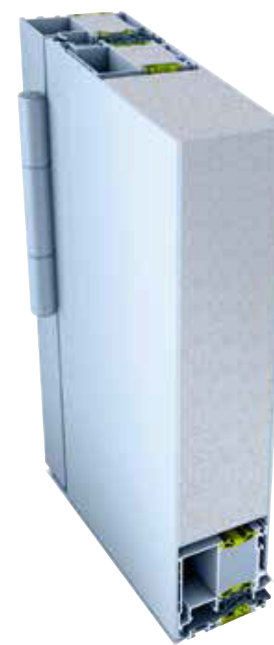
EGE SYSTEM 92 mit beidseitig aufgesetztem Türblatt in 92mm (geschlossen) U_D = 0,70 / Passivhausniveau!
