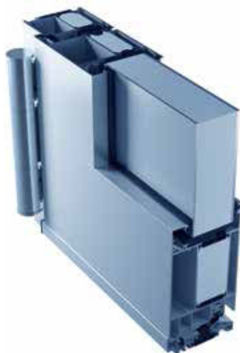
EGE SYSTEM 82 mit eingesetztem Türblatt - in 36mm (geschlossen) U_D = 1,2 - in 48mm THERMO (geschlossen) U_D = 1,1
