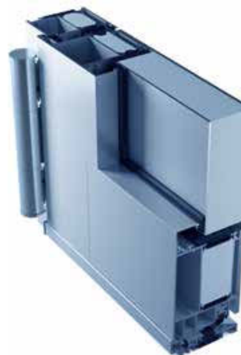
EGE SYSTEM 82 mit außen aufgesetztem Türblatt - in 38mm (geschlossen) U_D = 1,2 - in 48mm THERMO (geschlossen) U_D = 1,1
